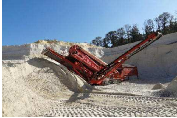
Illustration : unité mobile de scalpage/criblage (Source : présentation de la demande, page 13)
